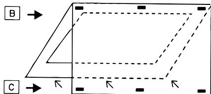
Otez le protecteur des scratchs situés en haut du film et appliquez-les soigneusement sur la partie haute du châssis [B]. Puis réalisez la même opération sur la partie basse [C].
